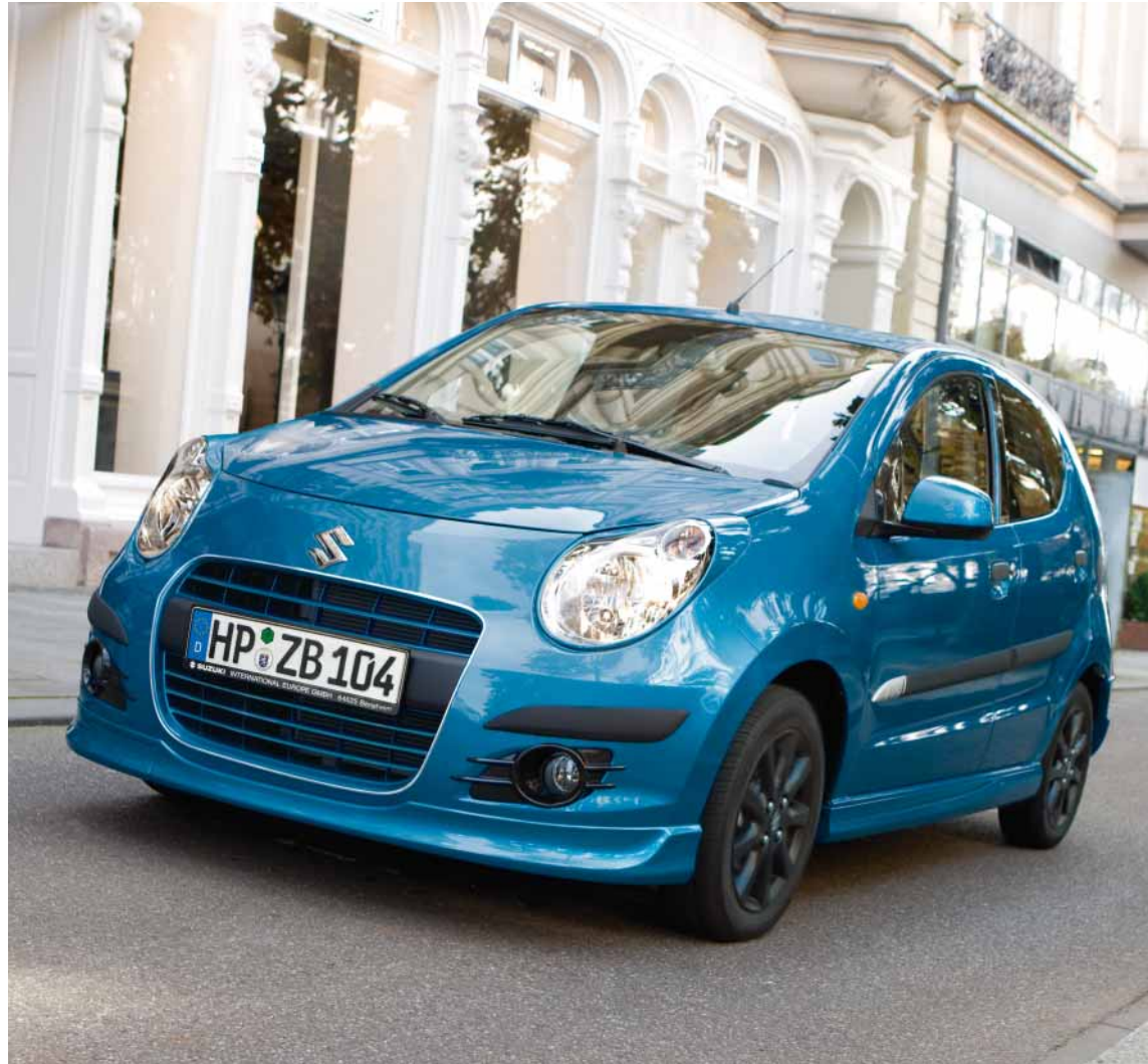
Scheinwerfer Cover, Frontgrill Dekor, Frontspoiler, Seitenspoiler, Alufelgen „Helsinki“ schwarz, Seitenschutzleisten
