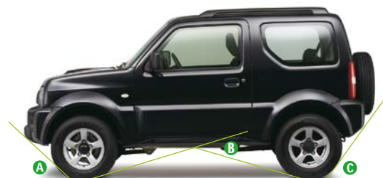
A 34° přední nájezdový úhel B 31° přechodový úhel C 46° zadní nájezdový úhel (základní nastavení bez nákladu)
