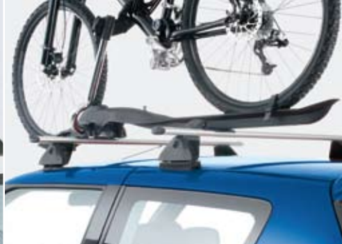
Střešní nosič jízdních kol „Baracuda“ 1,2 upevňovací rameno lze namontovat vlevo nebo vpravo (na obrázku Suzuki Swift) obj. čís. 99000-990YT-206
