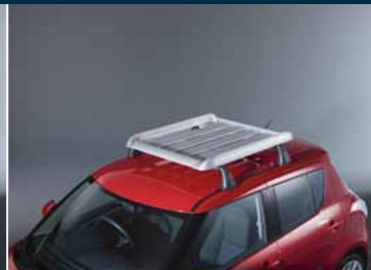
15 | Gepäckkorb 1 Aluminium, zum Transport von Dachlasten, 114 x 96 x 11 cm Art.-Nr. 99000-990YT-406
