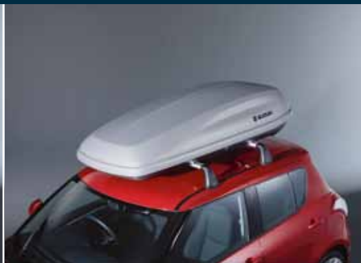
14 | Dachbox „Certo silver 460“ 1 mit Master-Fit Schnellbefestigung, kann von beiden Seiten geöffnet werden. Vol. 440 l, 192 x 82 x 42 cm. Art.-Nr. 990E0-59J43-000
